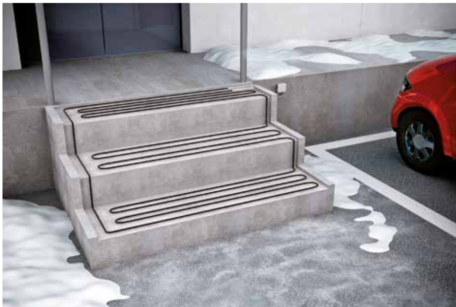
Tash jest staloporowym kablem grzejnym przeznaczonym do ogrzewania obszarów o różnych kształtach i powierzchni. Kabel Tash należy zawsze instalować jako pętlę, żeby oba jego końce połączyć w puszcze z przewodami zimnymi. (RYSUNEK POGLĄDOWY)
